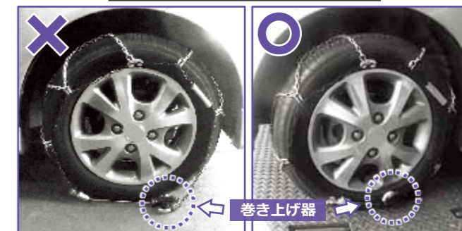
巻き上げ器が緩んでいる
