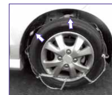
チェーンが車両内側に脱落
